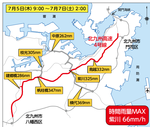
図8-2-5 公社雨量計による降雨量データ
