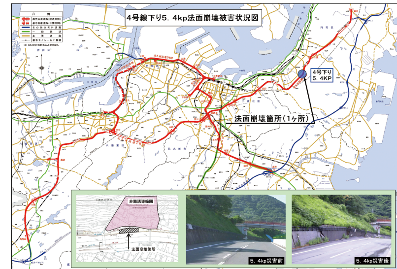
図8-2-4 平成22年梅雨前線豪雨による被災状況
